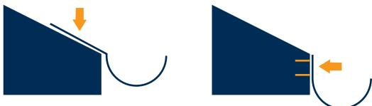
**Los soportes largos** son los más seguros, ya que se fijan directamente sobre la estructura de la cubierta. El único inconveniente es que han de colocarse antes de la colocación de la cubierta final, ya sea teja o similar.
